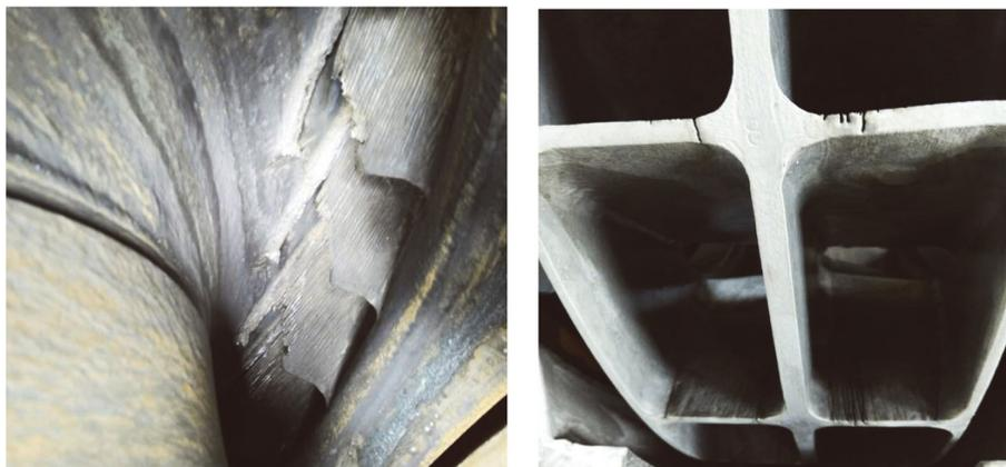
图3 风机叶轮腐蚀情况
