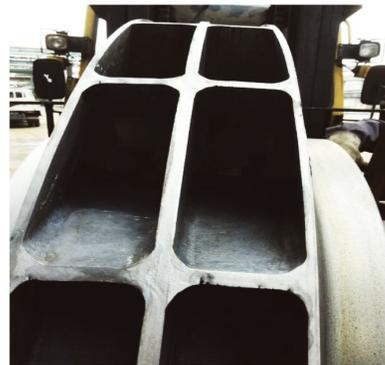
图2 风机叶轮导流板腐蚀
